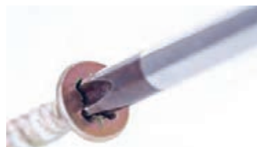
الف) استفاده صحیح از آچار پیچ گوشتی
