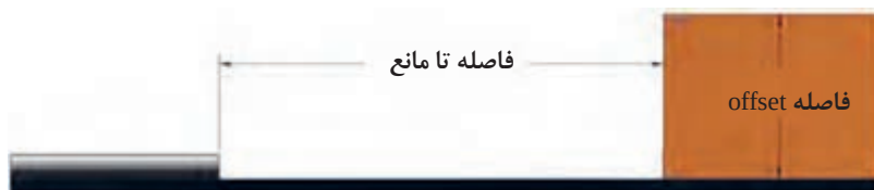
شکل ۳۰- اندازه‌گیری خم انحرافی
