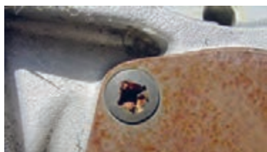
ب) استفاده ناصحیح از آچار پیچ گوشتی
