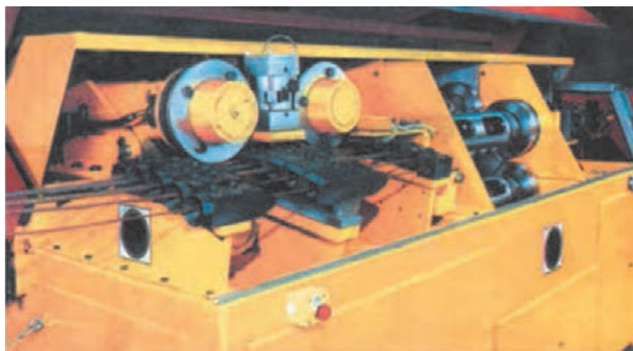
شکل ۲۹ - دستگاه کشش برقی برای صاف کردن میلگرد ▲
