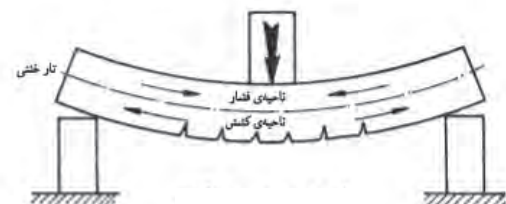
شکل ۱۴-۱ - تیر بتنی پس از بارگذاری ▲
