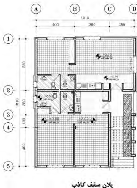
تصویر ۱- پلان اندازه گذاری معماری و پلان سقف کاذب یک ساختمان اقامتی دو واحدی
