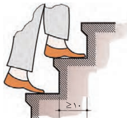
شکل ۱۶-۳ کوچک‌ترین اندازه‌ی کف پله در پله‌های پیچ
